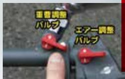
重曹とエアーを調整できる2つのバルブを搭載。サビ落とし後にツマミ切り替えてエアーダスターガンに！重曹をシュッと吹き飛ばせるので後処理も楽に！
