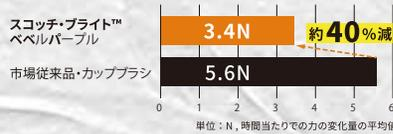
※口ボット研磨で約30cmの塗装剥ぎを実施した社内テストデータ。材質や環境等、お客様の実際の使用条件によって結果は異なります。
